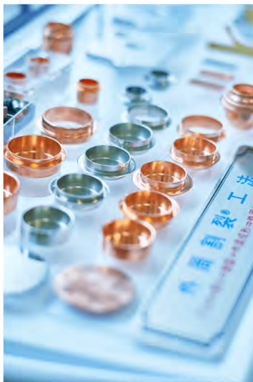
割裂®を応用し、丸材、パイプ材の外周を裂く「外周割裂®」
